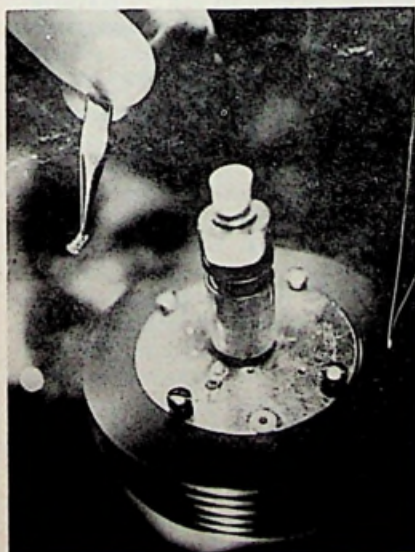
Een gunn-element ter grootte van 4 mm tezamen met een koelinrichting van de microgolffzender.
