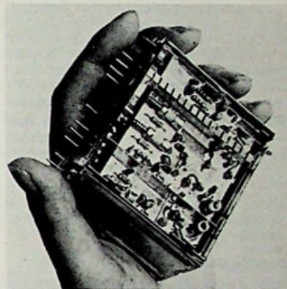
Afb. 3. Varituner type 162 met geopende VHF-zijde van AEG-Telefunken.
